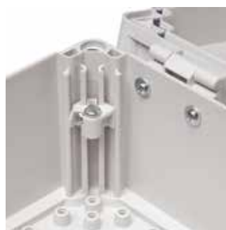
Verstellbare Distanzstücke für die Eckschlitz der Ensto Cubo O, C und W Gehäuseunterteile ermöglichen die stufenlose Höhenanpassung von Montage- oder Frontplatte.
