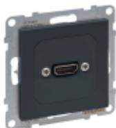
SEANO HDMI 1.3 Anschlussinheit vorverdrahtet inkl. Anschlusskabel mit Kabellänge 15 cm. Der Einsatz ist für Spreizkrallen- und Schraubbefestigung geeignet und wird mit transparenter Staubschutzabdeckung geliefert. Zum Komplettieren mit Abdeckrahmen der Serien SEANO, SEANO+ und SEANO Natura. Auslieferung inkl. Abdeckung in der Farbausführung Anthrazit lackiert.
