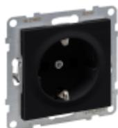
SEANO Schutzkontakt-Steckdose 16 A, 250 V mit Steckklemmen und mit erhöhtem Berührungsschutz. Die SEANO-Einsätze sind für Spreizkrallen- und Schraubbefestigung geeignet und werden mit transparenter Staubschutzabdeckung geliefert. Verwendbar für den Anschluss von starren und flexiblen Leitern mittels Steckklemmen (SL). Zum Komplettieren mit Abdeckrahmen von SEANO, SEANO+ und SEANO Natura. Geliefert in der Profiverpackung (Kartonbox). Farbausführung: Schwarz lackiert
