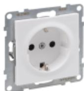
SEANO Schutzkontakt-Steckdose 16 A, 250 V mit Steckklemmen und mit erhöhtem Berührungsschutz. Die SEANO-Einsätze sind für Spreizkrallen- und Schraubbefestigung geeignet und werden mit transparenter Staubschutzabdeckung geliefert. Verwendbar für den Anschluss von starren und flexiblen Leitern mittels Steckklemmen (SL). Zum Komplettieren mit Abdeckrahmen von SEANO, SEANO+ und SEANO Natura. Geliefert in der Profiverpackung (Kartonbox). Farbausführung: Ultraweiß
