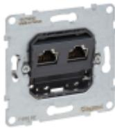
SEANO Einsatz Datendose 2 x RJ45, Kat. 6A, STP, geschirmt, werkzeuglose Anschluss technik LCS2 mit Schnellanschluss-Schneidklemmen, farbmarkierte Anschlüsse für Belegungsart nach EIA/TIA 568 A und B. Konform nach ISO 11801, EN 50173 und EIA/TIA 568. Der Einsatz ist für Spreizkrallen- und Schraubbefestigung geeignet und wird mit transparenter Staubschutzabdeckung geliefert. Zum Komplettieren mit Abdeckrahmen der Serien SEANO, SEANO+ und SEANO Natura.
