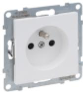
SEANO internationale Steckdose französischer/ belgischer Standard 16 A, 250 V mit Steckklemmen und mit erhöhtem Berührungsschutz. Die SEANO-Einsätze sind für Spreizkrallen- und Schraubbefestigung geeignet und werden mit transparenter Staubschutzabdeckung geliefert. Verwendbar für den Anschluss von starren und flexiblen Leitern mittels Steckklemmen (SL). Zum Komplettieren mit Abdeckrahmen von SEANO, SEANO+ und SEANO Natura. Geliefert in der Profiverpackung (Kartonbox). Farbausführung: Ultraweiß
