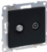
Seano TV-SAT-Anschlussdose für 2 Kabel mit Anschlussdämpfung 1,5 dB. TV: 5 – 68/120 – 862 MHz, SAT: 950 – 2400 MHz. TV-Buchse „männlich“ (Ø 9.5 mm), SAT-Buchse „F-Typ“. Schnellanschlusstechnik mit 1/4 - Drehung. Der Einsatz ist für Spreizkrallen- und Schraubbefestigung geeignet und wird mit transparenter Staubschutzabdeckung geliefert. Auslieferung inkl. Abdeckung in der Farbausführung Ultraweiß. Zum Komplettieren mit Abdeckrahmen der Serien SEANO, SEANO+ und SEANO Natura.
