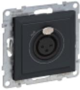
SEANO XLR-Dose 3-polig weiblich mit Schraubklemmenanschluss 0,5 mm<sup>2</sup>. Der Einsatz ist für Spreizkrallen- und Schraubbefestigung geeignet und wird mit transparenter Staubschutzabdeckung geliefert. Zum Komplettieren mit Abdeckrahmen der Serien SEANO, SEANO+ und SEANO Natura. Auslieferung inkl. Abdeckung in der Farbausführung Anthrazit lackiert.
