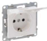
SEANO Schutzkontakt-Steckdose 16 A, 250V mit Steckklemmen und mit erhöhtem Berührungsschutz sowie Klappdeckel IP21. Die SEANO-Einsätze sind für Spreizkrallen- und Schraubbefestigung geeignet und werden mit transparenter Staubschutzabdeckung geliefert. Verwendbar für den Anschluss von starren und flexiblen Leitern mittels Steckklemmen (SL). Zum Komplettieren mit Abdeckrahmen von SEANO, SEANO+ und SEANO Natura. Geliefert in der Profiverpackung (Kartonbox). Farbausführung: Ultraweiß
