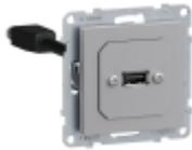
SEANO USB-Datendose 3.0 inkl. Anschlusskabel mit Kabellänge 15 cm. Der Einsatz ist für Spreizkrallen- und Schraubbefestigung geeignet und wird mit transparenter Staubschutzabdeckung geliefert. Zum Komplettieren mit Abdeckrahmen der Serien SEANO, SEANO+ und SEANO Natura. Auslieferung inkl. Abdeckung in der Farbausführung Aluminium lackiert.
