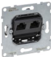
SEANO Einsatz Datendose 2 x RJ45, Kat. 5e, UTP, ungeschirmt, werkzeuglose Anschluss technik LCS2 mit Schnellanschluss-Schneidklemmen, farbmarkierte Anschlüsse für Belegungsart nach EIA/TIA 568 A und B. Konform nach ISO 11801, EN 50173 und EIA/TIA 568. Der Einsatz ist für Spreizkrallen- und Schraubbefestigung geeignet und wird mit transparenter Staubschutzabdeckung geliefert. Zum Komplettieren mit Abdeckrahmen der Serien SEANO, SEANO+ und SEANO Natura.
