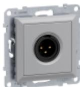
SEANO XLR-Dose 3-polig männlich mit Schraubklemmenanschluss 0,5 mm<sup>2</sup>. Der Einsatz ist für Spreizkrallen- und Schraubbefestigung geeignet und wird mit transparenter Staubschutzabdeckung geliefert. Zum Komplettieren mit Abdeckrahmen der Serien SEANO, SEANO+ und SEANO Natura. Auslieferung inkl. Abdeckung in der Farbausführung Aluminium lackiert.
