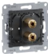
SEANO Einsatz 1-fach Lautsprecher-Anschlussdose mit vergoldeten 4 mm Messing-Buchsen für erstklassige Signalübertragung. Der Einsatz ist für Spreizkrallen- und Schraubbefestigung geeignet und wird mit transparenter Staubschutzabdeckung geliefert. Die Abdeckung ist nicht im Lieferumfang und muss separat bestellt werden. Zum Komplettieren mit Abdeckrahmen der Serien SEANO, SEANO+ und SEANO Natura.
