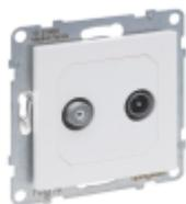
Seano TV-SAT-Anschlussdose für 2 Kabel mit Anschlussdämpfung 1,5 dB. TV: 5 – 68/120 – 862 MHz, SAT: 950 – 2400 MHz. TV-Buchse „männlich“ (Ø 9.5 mm), SAT-Buchse „F-Typ“. Schnellanschlusstechnik mit 1/4 - Drehung. Der Einsatz ist für Spreizkrallen- und Schraubbefestigung geeignet und wird mit transparenter Staubschutzabdeckung geliefert. Auslieferung inkl. Abdeckung in der Farbausführung Schwarz lackiert. Zum Komplettieren mit Abdeckrahmen der Serien SEANO, SEANO+ und SEANO Natura.
