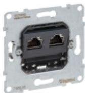
SEANO Einsatz Datendose 2 x RJ45, Kat. 6A, UTP, ungeschirmt, werkzeuglose Anschluss technik LCS2 mit Schnellanschluss-Schneidklemmen, farbmarkierte Anschlüsse für Belegungsart nach EIA/TIA 568 A und B. Konform nach ISO 11801, EN 50173 und EIA/TIA 568. Der Einsatz ist für Spreizkrallen- und Schraubbefestigung geeignet und wird mit transparenter Staubschutzabdeckung geliefert. Zum Komplettieren mit Abdeckrahmen der Serien SEANO, SEANO+ und SEANO Natura.
