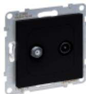
Seano TV-SAT-Anschlussdose für 2 Kabel mit Anschlussdämpfung 1,5 dB. TV: 5 – 68/120 – 862 MHz, SAT: 950 – 2400 MHz. TV-Buchse „männlich“ (Ø 9.5 mm), SAT-Buchse „F-Typ“. Schnellanschlusstechnik mit 1/4 - Drehung. Der Einsatz ist für Spreizkrallen- und Schraubbefestigung geeignet und wird mit transparenter Staubschutzabdeckung geliefert. Auslieferung inkl. Abdeckung in der Farbausführung Anthrazit lackiert. Zum Komplettieren mit Abdeckrahmen der Serien SEANO, SEANO+ und SEANO Natura.
