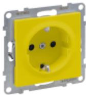
SEANO Schutzkontakt-Steckdose 16 A, 250 V mit Steckklemmen und mit erhöhtem Berührungsschutz. Die SEANO-Einsätze sind für Spreizkrallen- und Schraubbefestigung geeignet und werden mit transparenter Staubschutzabdeckung geliefert. Verwendbar für den Anschluss von starren und flexiblen Leitern mittels Steckklemmen (SL). Zum Komplettieren mit Abdeckrahmen von SEANO, SEANO+ und SEANO Natura. Geliefert in der Profiverpackung (Kartonbox). Farbausführung: Gelb
