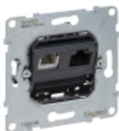
SEANO Einsatz Datendose RJ11 + RJ45, KAT. 6 UTP, Kombinationsdose mit RJ11-Anschluss für Telefon und Datenanschluss RJ45 (Kat. 6, UTP, ungeschirmt). Der Einsatz ist für Spreizkrallen- und Schraubbefestigung geeignet und wird mit transparenter Staubschutzabdeckung geliefert. Die Abdeckung ist nicht im Lieferumfang und muss separat bestellt werden. Zum Komplettieren mit Abdeckrahmen der Serien SEANO, SEANO+ und SEANO Natura.
