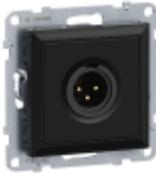
SEANO XLR-Dose 3-polig männlich mit Schraubklemmenanschluss 0,5 mm<sup>2</sup>. Der Einsatz ist für Spreizkrallen- und Schraubbefestigung geeignet und wird mit transparenter Staubschutzabdeckung geliefert. Zum Komplettieren mit Abdeckrahmen der Serien SEANO, SEANO+ und SEANO Natura. Auslieferung inkl. Abdeckung in der Farbausführung Schwarz lackiert.
