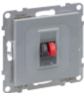
SEANO Lautsprecher-Anschlussdose 1-fach mit Federklemmen (Rot/Schwarz). Der Einsatz ist für Spreizkrallen- und Schraubbefestigung geeignet und wird mit transparenter Staubschutzabdeckung geliefert. Auslieferung inkl. Abdeckung in der Farbausführung Aluminium lackiert. Zum Komplettieren mit Abdeckrahmen der Serien SEANO, SEANO+ und SEANO Natura.
