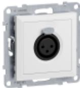
SEANO XLR-Dose 3-polig weiblich mit Schraubklemmenanschluss 0,5 mm<sup>2</sup>. Der Einsatz ist für Spreizkrallen- und Schraubbefestigung geeignet und wird mit transparenter Staubschutzabdeckung geliefert. Zum Komplettieren mit Abdeckrahmen der Serien SEANO, SEANO+ und SEANO Natura. Auslieferung inkl. Abdeckung in der Farbausführung Ultraweiß.
