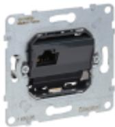
SEANO Einsatz Datendose RJ45, Kat. 6, UTP, ungeschirmt, werkzeuglose Anschlussstechnik LCS2 mit Schnellanschluss-Schneidklemmen, farbmarkierte Anschlüsse für Belegungsart nach EIA/TIA 568 A und B. Konform nach ISO 11801, EN 50173 und EIA/TIA 568. Der Einsatz ist für Spreizkrallen- und Schraubbefestigung geeignet und wird mit transparenter Staubschutzabdeckung geliefert. Zum Komplettieren mit Abdeckrahmen der Serien SEANO, SEANO+ und SEANO Natura.
