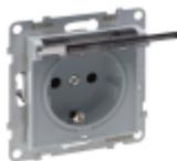
SEANO Schutzkontakt-Steckdose 16 A, 250V mit Steckklemmen und mit erhöhtem Berührungsschutz sowie Klappdeckel IP21. Die SEANO-Einsätze sind für Spreizkrallen- und Schraubbefestigung geeignet und werden mit transparenter Staubschutzabdeckung geliefert. Verwendbar für den Anschluss von starren und flexiblen Leitern mittels Steckklemmen (SL). Zum Komplettieren mit Abdeckrahmen von SEANO, SEANO+ und SEANO Natura. Geliefert in der Profiverpackung (Kartonbox). Farbausführung: Aluminium lackiert
