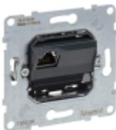
SEANO Einsatz Datendose RJ45, Kat. 6A, STP, geschirmt, werkzeuglose Anschluss technik LCS2 mit Schnellanschluss-Schneidklemmen, farbmarkierte Anschlüsse für Belegungsart nach EIA/TIA 568 A und B. Konform nach ISO 11801, EN 50173 und EIA/TIA 568. Der Einsatz ist für Spreizkrallen- und Schraubbefestigung geeignet und wird mit transparenter Staubschutzabdeckung geliefert. Zum Komplettieren mit Abdeckrahmen der Serien SEANO, SEANO+ und SEANO Natura.
