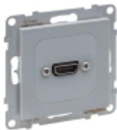
SEANO HDMI 1.3 Anschlusseinheit vorverdrahtet inkl. Anschlusskabel mit Kabellänge 15 cm. Der Einsatz ist für Spreizkrallen- und Schraubbefestigung geeignet und wird mit transparenter Staubschutzabdeckung geliefert. Zum Komplettieren mit Abdeckrahmen der Serien SEANO, SEANO+ und SEANO Natura. Auslieferung inkl. Abdeckung in der Farbausführung Aluminium lackiert.
