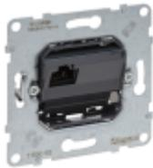
SEANO Einsatz Datendose RJ45, Kat. 5e, UTP, ungeschirmt, werkzeuglose Anschlussstechnik LCS2 mit Schnellanschluss-Schneidklemmen, farbmarkierte Anschlüsse für Belegungsart nach EIA/TIA 568 A und B. Konform nach ISO 11801, EN 50173 und EIA/TIA 568. Der Einsatz ist für Spreizkrallen- und Schraubbefestigung geeignet und wird mit transparenter Staubschutzabdeckung geliefert. Zum Komplettieren mit Abdeckrahmen der Serien SEANO, SEANO+ und SEANO Natura.
