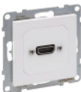
SEANO HDMI 1.3 Anschlusseinheit vorverdrahtet inkl. Anschlusskabel mit Kabellänge 15 cm. Der Einsatz ist für Spreizkrallen- und Schraubbefestigung geeignet und wird mit transparenter Staubschutzabdeckung geliefert. Zum Komplettieren mit Abdeckrahmen der Serien SEANO, SEANO+ und SEANO Natura. Auslieferung inkl. Abdeckung in der Farbausführung Ultraweiß.
