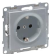
SEANO Schutzkontakt-Steckdose 16 A, 250 V mit Steckklemmen und mit erhöhtem Berührungsschutz. Die SEANO-Einsätze sind für Spreizkrallen- und Schraubbefestigung geeignet und werden mit transparenter Staubschutzabdeckung geliefert. Verwendbar für den Anschluss von starren und flexiblen Leitern mittels Steckklemmen (SL). Zum Komplettieren mit Abdeckrahmen von SEANO, SEANO+ und SEANO Natura. Geliefert in der Profiverpackung (Kartonbox). Farbausführung: Aluminium lackiert
