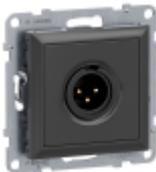
SEANO XLR-Dose 3-polig männlich mit Schraubklemmenanschluss 0,5 mm<sup>2</sup>. Der Einsatz ist für Spreizkrallen- und Schraubbefestigung geeignet und wird mit transparenter Staubschutzabdeckung geliefert. Zum Komplettieren mit Abdeckrahmen der Serien SEANO, SEANO+ und SEANO Natura. Auslieferung inkl. Abdeckung in der Farbausführung Anthrazit lackiert.
