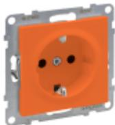
SEANO Schutzkontakt-Steckdose 16 A, 250 V mit Steckklemmen und mit erhöhtem Berührungsschutz. Die SEANO-Einsätze sind für Spreizkrallen- und Schraubbefestigung geeignet und werden mit transparenter Staubschutzabdeckung geliefert. Verwendbar für den Anschluss von starren und flexiblen Leitern mittels Steckklemmen (SL). Zum Komplettieren mit Abdeckrahmen von SEANO, SEANO+ und SEANO Natura. Geliefert in der Profiverpackung (Kartonbox). Farbausführung: Orange
