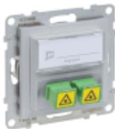
SEANO SC/APC Monomode Glasfaser-Steckdose für den Anschluss von 2 Glasfaserkabeln mit einem 1 Duplex Adapter. Der Einsatz ist für Spreizkrallen- und Schraubbefestigung geeignet und wird mit transparenter Staubschutzabdeckung geliefert. Zum Komplettieren mit Abdeckrahmen der Serien SEANO, SEANO+ und SEANO Natura. Auslieferung inkl. Abdeckung in der Farbausführung Aluminium lackiert.
