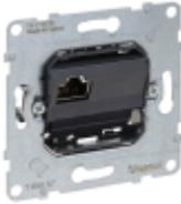
SEANO Datendose RJ45, Kat. 6A, UTP, ungeschirmt, werkzeuglose Anschluss technik LCS2 mit Schnellanschluss-Schneidklemmen, farbmarkierte Anschlüsse für Belegungsart nach EIA/TIA 568 A und B. Konform nach ISO 11801, EN 50173 und EIA/TIA 568. Der Einsatz ist für Spreizkrallen- und Schraubbefestigung geeignet und wird mit transparenter Staubschutzabdeckung geliefert. Zum Komplettieren mit Abdeckrahmen der Serien SEANO, SEANO+ und SEANO Natura.
