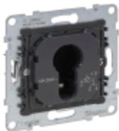
Schlüssel-Jalousietaster für DIN-Halbzylinder, DIN-Profil Schlüsseltaster Jalousie, 2-polig; 6 A – 250 V~; Einbautiefe: 45 mm (Tiefe der AP-Gehäuse bzw. Installationsdosen beachten). Zur Verwendung mit DIN-Halbzylinder 40 mm (z. B. Best.Nr. 069795). Die Abdeckung ist nicht im Lieferumfang und ist separat zu bestellen. Zum Komplettieren mit den Abdeckrahmen der Serien SEANO, SEANO+ und SEANO Natura.
