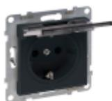
SEANO Schutzkontakt-Steckdose 16 A, 250V mit Steckklemmen und mit erhöhtem Berührungsschutz sowie Klappdeckel IP21. Die SEANO-Einsätze sind für Spreizkrallen- und Schraubbefestigung geeignet und werden mit transparenter Staubschutzabdeckung geliefert. Verwendbar für den Anschluss von starren und flexiblen Leitern mittels Steckklemmen (SL). Zum Komplettieren mit Abdeckrahmen von SEANO, SEANO+ und SEANO Natura. Geliefert in der Profiverpackung (Kartonbox). Farbausführung: Anthrazit lackiert
