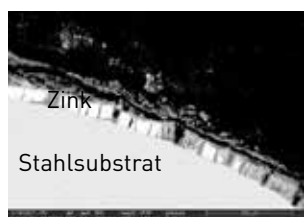
Querschnitt HDG x 200 nach dem Falten, dann nach 550 h Salzsprühtest
