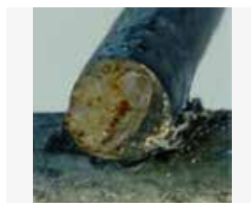
Oberflächlicher roter Rost auf der Schnittfläche
