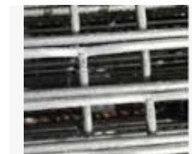
Oberflächlicher roter Rost auf der Schnittfläche
