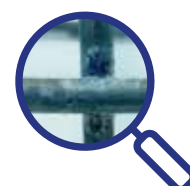
Weiße Lichthöfe an der Schweißnaht
