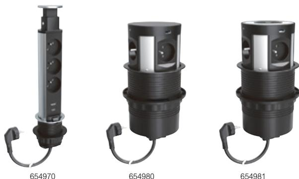
Zum Einbau in Möbel, französische Steckdose, 16 A – 250 V~ 50/60 Hz, mit erhöhtem Berührungsschutz, USB-Ladesteckdose Typ A+C, Spannungsversorgung: 110-240 V 50/60 Hz, Ausgangsspannung 5 V mit maximalem Ladestrom von 3000 mA bei einem Gerät oder 1500 mA pro Ausgang bei gleichzeitigem Laden von 2 Geräten. Entspricht der Norm IEC 62368-1, mit 2 m langem Kabel und 2P+T-Stecker.
