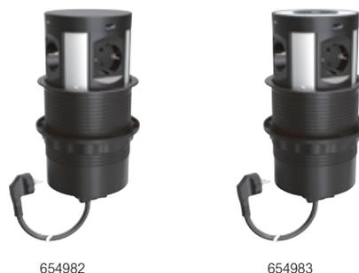
Zum Einbau in Möbel, Schutzkontakt Steckdose, 16 A – 250 V~ 50/60 Hz, mit erhöhtem Berührungsschutz. USB-Ladesteckdose Typ A+C, Spannungsversorgung: 110-240 V 50/60 Hz, Ausgangsspannung 5 V mit maximalem Ladestrom von 3000 mA bei einem Gerät oder 1500 mA pro Ausgang bei gleichzeitigem Laden von 2 Geräten. Entspricht der Norm IEC 62368-1, mit 2 m langem Kabel und 2P+T-Stecker.
