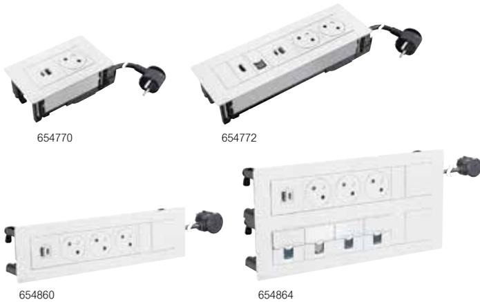
Zum Einbau in Möbel (horizontaler Einbau) oder in eine Zwischenwand (vertikaler Einbau), versenkbare französische Steckdose, 16 A – 250 V~ 50/60 Hz, mit erhöhtem Berührungsschutz. USB-Ladesteckdose Typ A+C, Spannungsversorgung: 110-240 V 50/60 Hz, Ausgangsspannung 5 V mit maximalem Ladestrom von 3000 mA bei einem Gerät oder 1500 mA pro Ausgang bei gleichzeitigem Laden von 2 Geräten. Entspricht der Norm IEC 62368-1, mit 2 m langem Kabel und 2P+T-Stecker.
