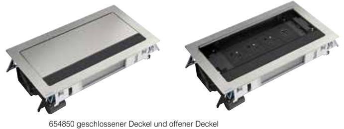
Zum Einbau in Möbel, Schutzkontakt Steckdose, 16 A – 250 V~ 50/60 Hz, mit erhöhtem Berührungsschutz. USB-Ladesteckdose Typ A+C, Spannungsversorgung: 110-240 V 50/60 Hz, Ausgangsspannung 5 V mit maximalem Ladestrom von 3000 mA bei einem Gerät oder 1500 mA pro Ausgang bei gleichzeitigem Laden von 2 Geräten. Entspricht der Norm IEC 62368-1, mit 2 m langem Kabel und 2P+T-Stecker.
